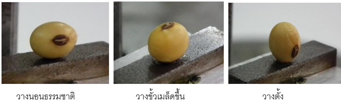
รูปที่ 3 การวางเมล็ดถั่วเหลืองเพื่อทดสอบการรับแรงกระแทก 3 รูปแบบ (รูปแบบวางหัวเมล็ดขึ้น และ วางตั้ง ใช้กาวแห้งเร็วช่วยยึดติด)
